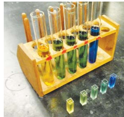
ภาพแสดงลักษณะของน้ำยาที่เปลี่ยนสีไปตามความเก่าของข้าว ที่ทำการตรวจสอบ
