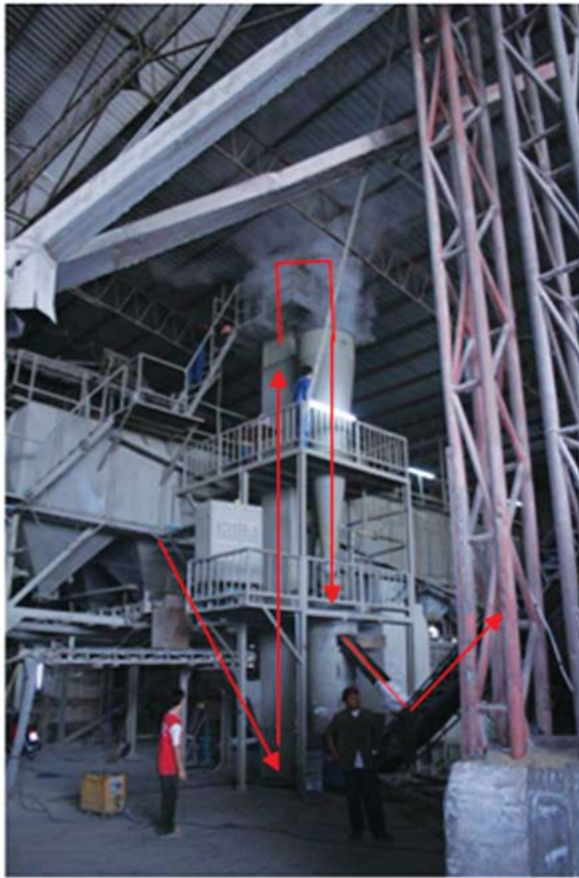
ภาพแสดงการปรับใช้ชุดผลิตข้าวหนึ่ง สำหรับการเร่งข้าวใหม่ให้เป็นข้าวเก่า ณ โรงสีเจริญพาณิชย์ จังหวัดพิษณุโลก
