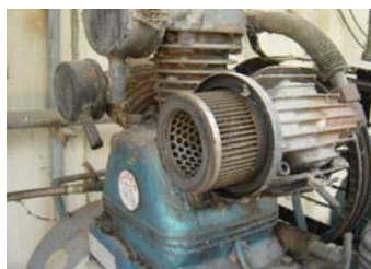
รูปที่ 2-3.49 ถังเก็บอากาศที่มีน้ำขัง กรองอากาศอุดตัน จุดเดรนระบายน้ำทั้งชำรุด
