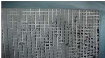
รูปที่ 2-3.48 เครื่องอัดอากาศขาดการบำรุงรักษาที่ชุดกรองอากาศก่อนเข้าเครื่อง
