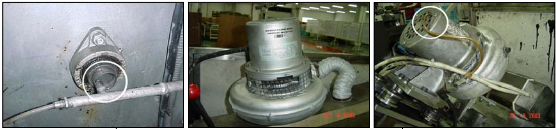
รูปที่ 2-3.31 การนำเอาอากาศอัดไปเป่าระบายความร้อนเครื่องจักร
