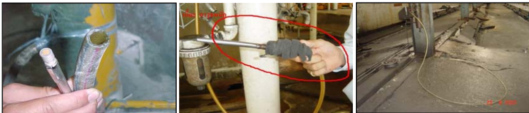
รูปที่ 2-3.32 การใช้ท่อสายยางหรือท่อเหล็กเป่าโดยตรงโดยไม่ใช้ปืนลม
