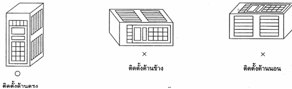
รูปที่ 1-2.17 ทิศทางการติดตั้งอินเวอร์เตอร์ [5]
