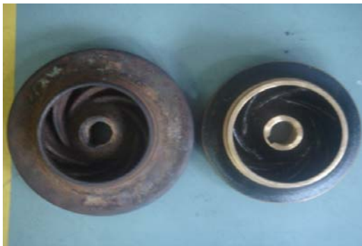
ภาพแสดงใบพัดก่อนและหลังการปรับปรุง
